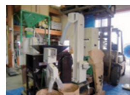
もみ摺り Hulling machine
